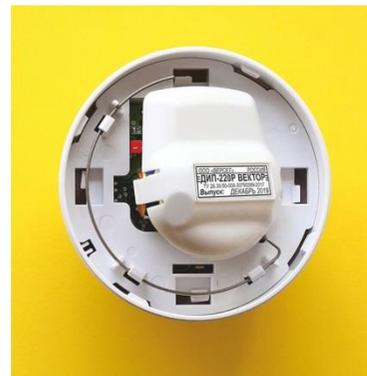
Для включения питания извещателя удалите (вытащите) бумажную ленту, изолирующую контакт основной батареи извещателя. Резервная батарея установлена и готова к работе.
